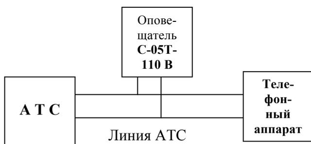
Оповещатель подключается напрямую к телефонной линии параллельно телефонному аппарату
